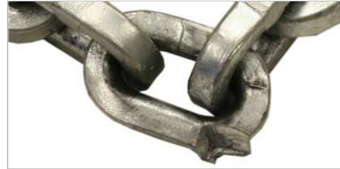
Zincir halkası, mekanik olarak hasar görmüştür.
